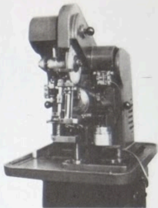
Автомат 3-306 для полировки профиля зубьев мелкозубчатых часовых трибов методом обката.
